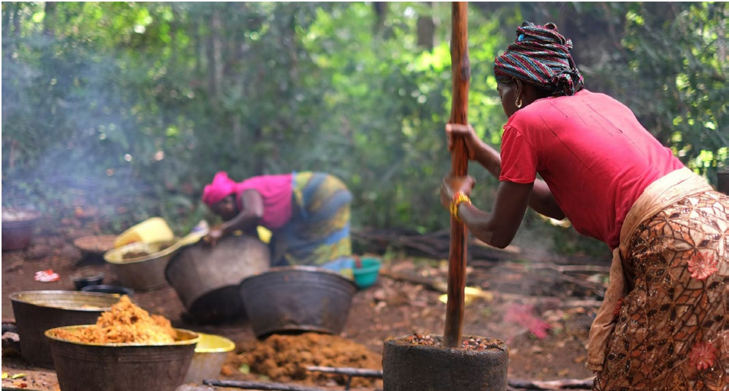
Figura 18 Extracción tradicional de aceite de palma en Guinea: primero se hierva el fruto de la palma aceitera, luego se tritura manualmente, e inmediatamente se utiliza en platos locales como la sopa Egusi., por Uzabiaga, 2017, Wikimedia Commons .
