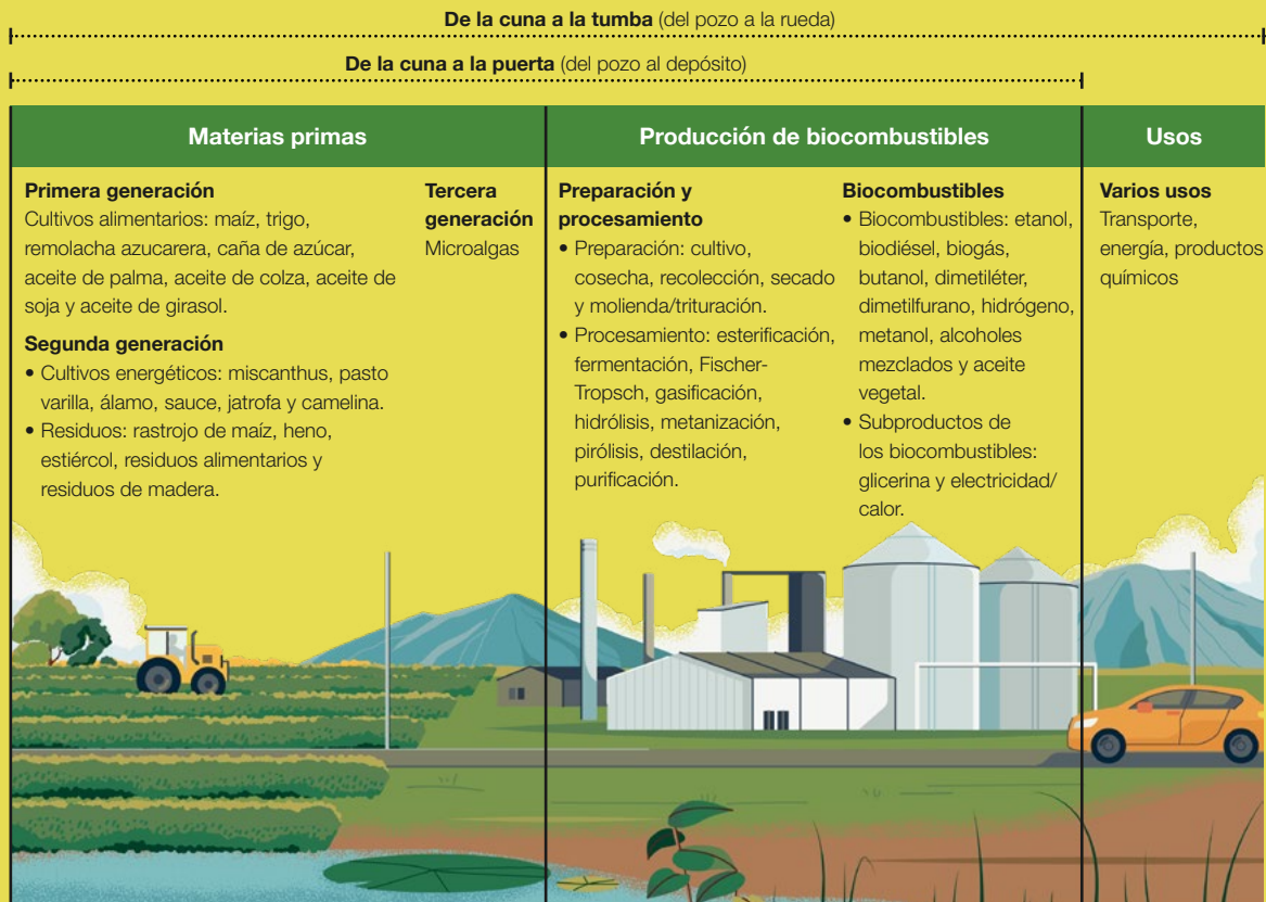
Figura 20 Resumen de las materias primas y los procesos de producción de los distintos biocombustibles, mostrando también el ciclo de vida de los combustibles de la cuna a la puerta (del pozo al depósito) y de la cuna a la tumba (del pozo a la rueda). Fuente: Elaborado por los editores del informe, adaptado de Jeswani et al. (2020) 86 .
